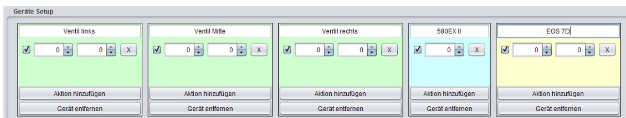
Illustration 2: Beispiel-Setup mit drei Magnetventilen, einem Blitz und einer Kamera
