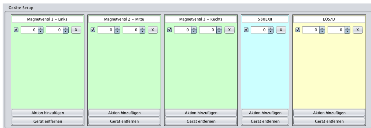
Illustration 2: Beispielsetup mit drei Magnetventilen, einem Blitz und einer Kamera
